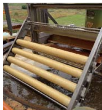
洗浄槽に設置したコラム
